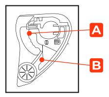
Para cambiar el visor, súbalo hasta la última posición (A) y accione la palanca ubicada en la figura (B) y hale el visor hacia afuera, para ponerlo nuevamente ubique el visor en la posición más alta y accione la palanca del sistema de visor, encaje y haga presión hacia adentro hasta oír un clic.
