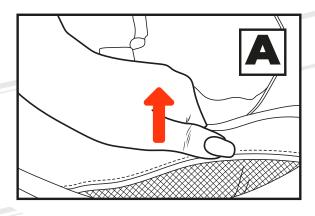
2. Para desmontar la corilla hale la parte posterior como lo muestra la figura (A), luego en la parte delantera desencaje las pestañas halando hacia afuera con un poco de fuerza (B).
