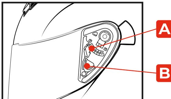
Para cambiar el visor, súbalo hasta la última posición (A) y accione la palanca ubicada en la figura (B) y hale el visor hacia afuera, para ponerlo nuevamente ubique el visor en la posición más alta y accione la palanca del sistema de visor, encaje y haga presión hacia adentro hasta oír un clic.
